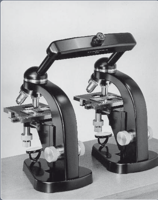
Vergleichsmikroskop mit Monokular-Einblick Fa. Ernst Leitz Wetzlar, Baujahr 1955
